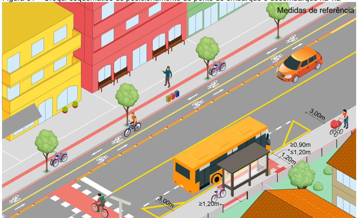
Figura 61 – Croqui esquemático de posicionamento do ponto de embarque e desembarque na via
