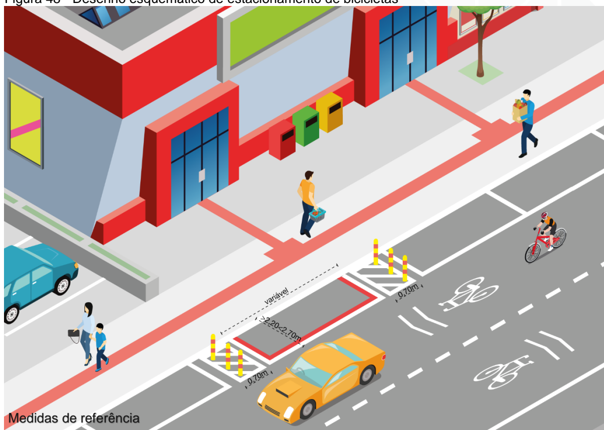
Figura 48 - Desenho esquemático de estacionamento de bicicletas
