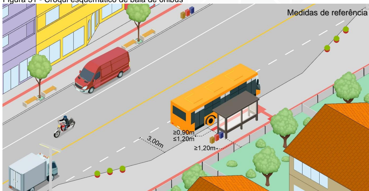
Figura 51 - Croqui esquemático de baia de ônibus
