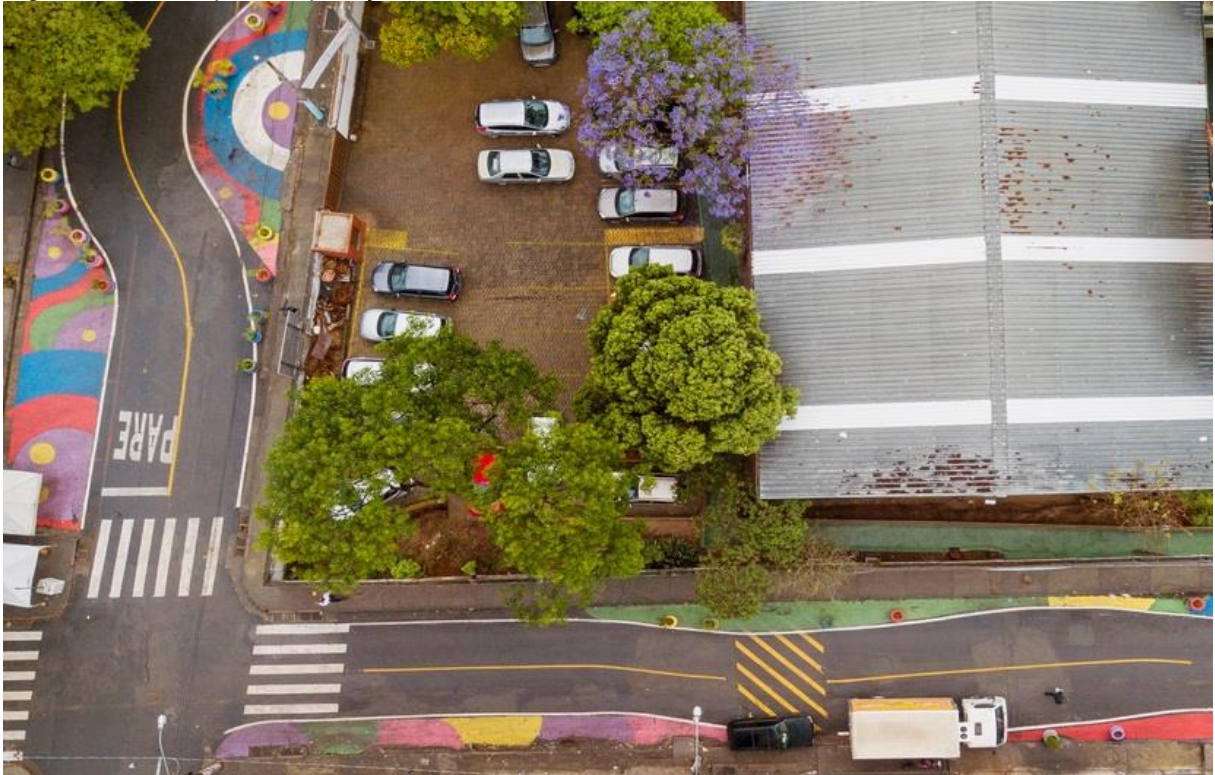
Figura 81 – Exemplo de aplicação de chicana com urbanismo tático
