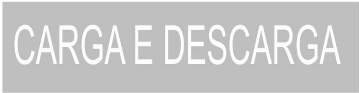
Figura 68 - Sinalização horizontal vaga para carga e descarga
