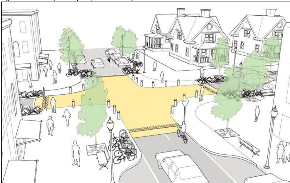
Figura 79 – Ilustração de aplicação de interseção elevada.
