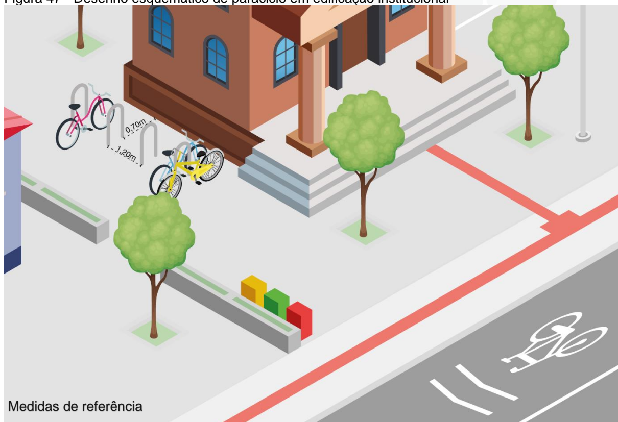
Figura 47 - Desenho esquemático de paraciclo em edificação institucional
